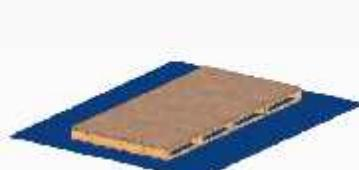
Uloženie dosiek na rovný povrch, izolované proti prenikaniu zemnej vlhkosti.
